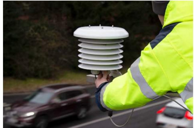
Messung von Lufttemperatur und Luftfeuchtigkeit
