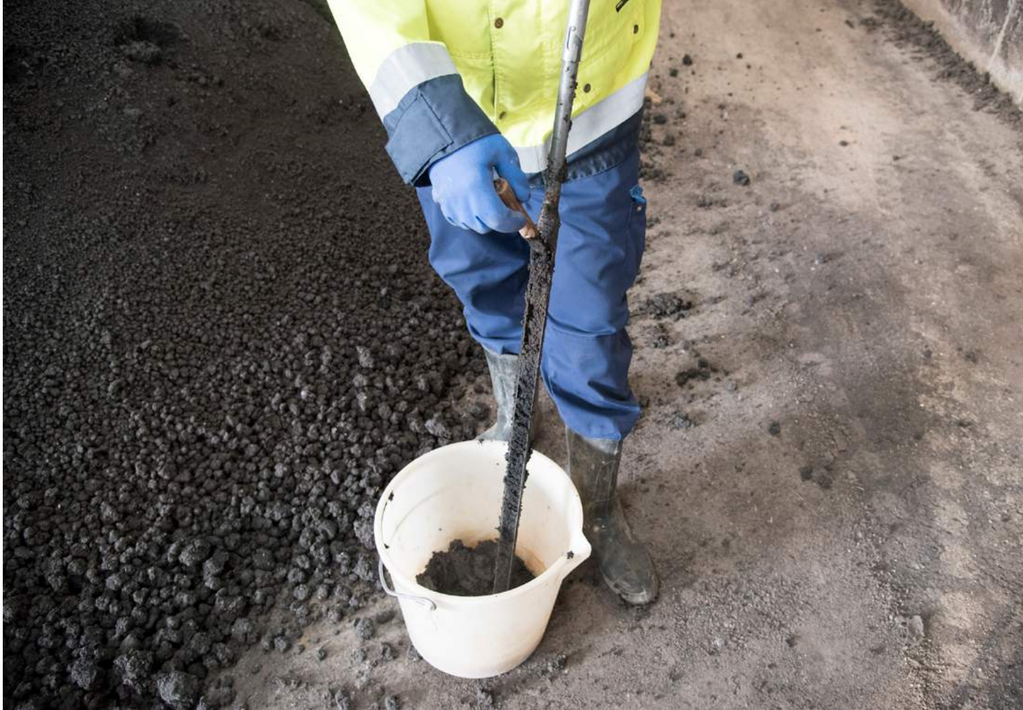
Probenahme bei Klärschlamm
