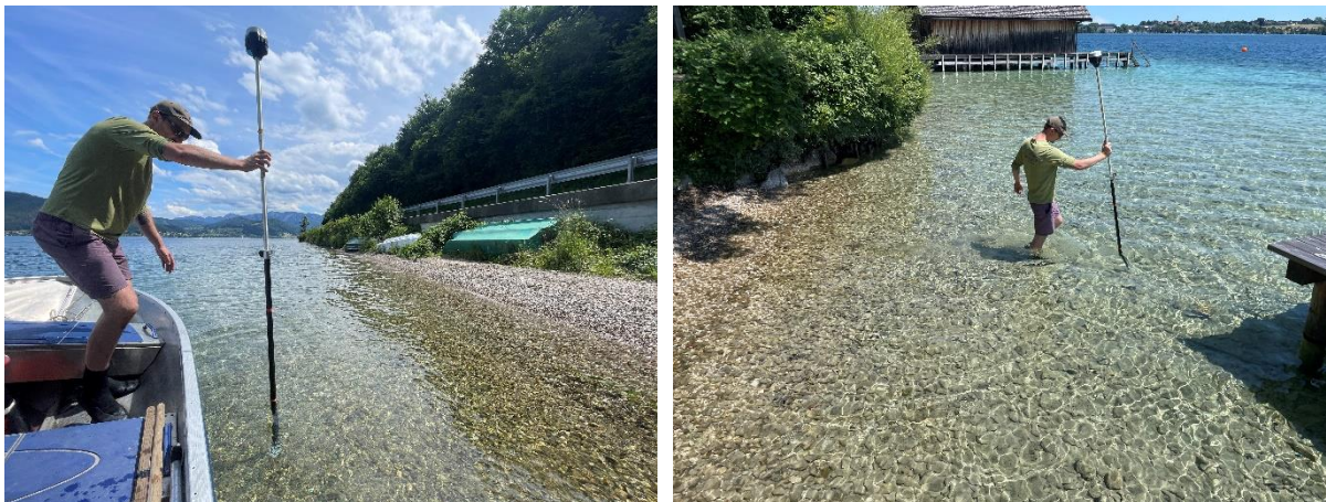
Abbildung 8: Eindrücke der Vermessung von Flachwasserzonen mittels GNSS-Messgerät. Vermessung einer kiesigen Flachwasserzone mit dem GNSS-Messgerät am Stab vom Boot aus, sowie die Vermessung mittels GNSS-Messgerät am Stab im seichten Wasser stehend.
