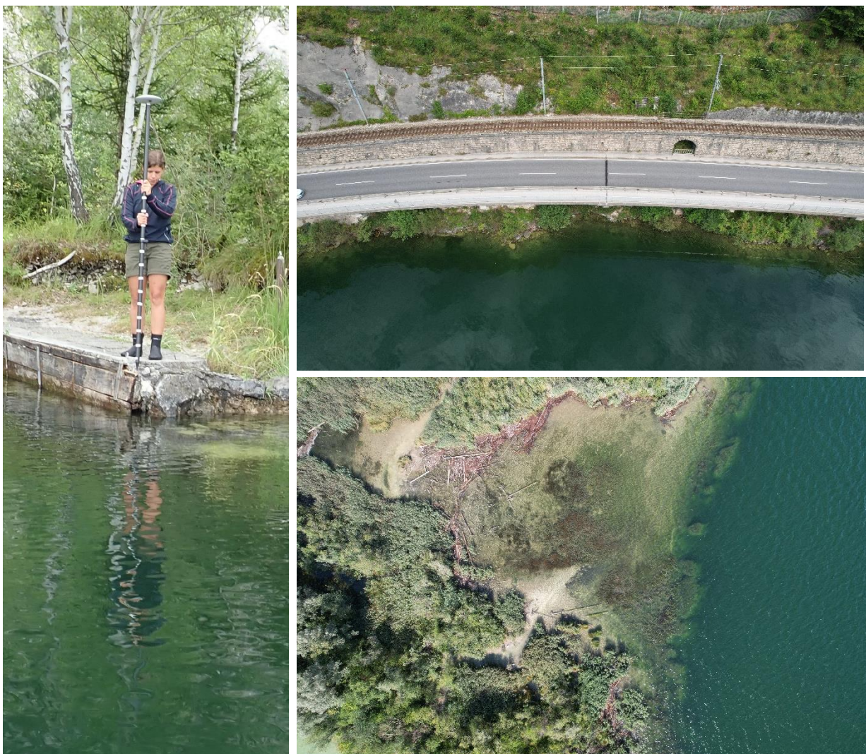
Abb. 5: Einmessung von Ufer- und Passpunkten sowie Bilder der Drohnenbefliegung.
