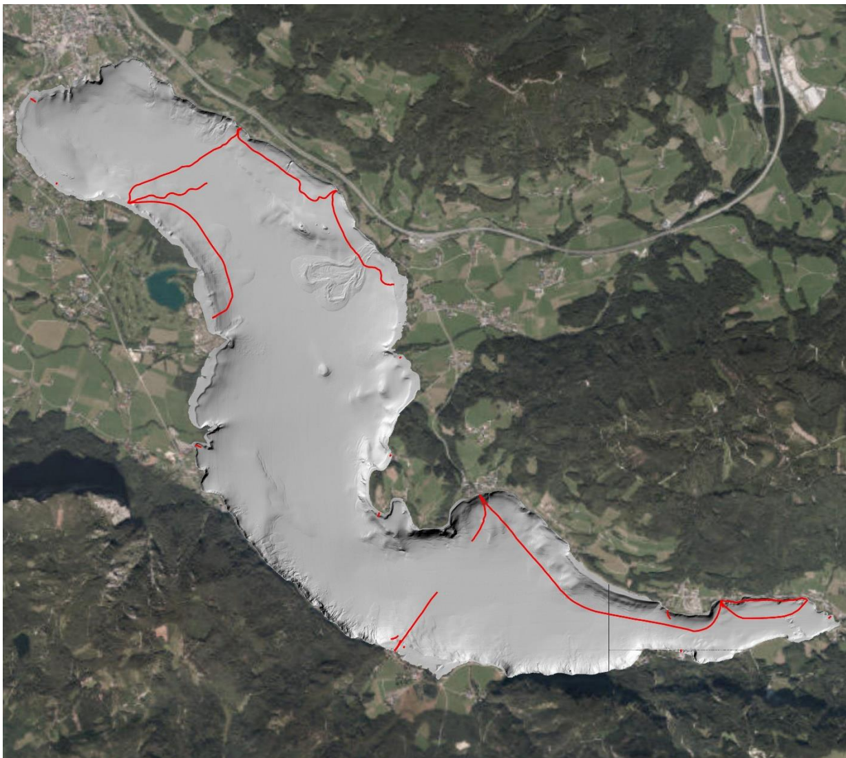
Abb. 3: Im Rahmen der gegenständlichen Bearbeitung detektierte Rohrleitungen (rot) des Reinhal- tungsverbands Mondsee-Irrsee. Luftbild: basemap.at
