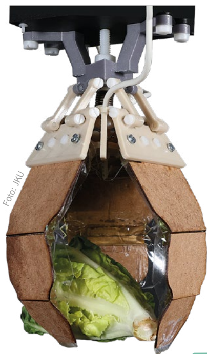
gripper lettuce - kompostierbarer Roboter-greifer
